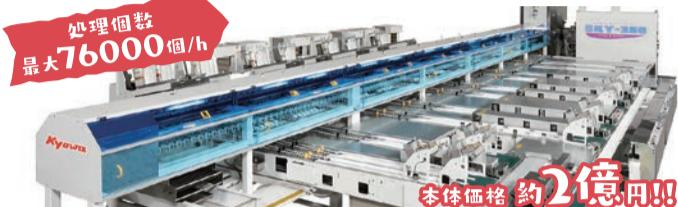
鶏卵流通の要である『GPセンター』における洗卵選別包装システム。弊社が選択したのは共和機械株式会社のSKYシリーズです。GPセンターに求められる幅広い機能性に加え、世界初となるキャリアカップ自動洗浄をはじめとする衛生管理にかかる様々な技術を投入し、お客様へ安心・安全な卵をお届けするための的確な対応を可能にした、まさに時代が求める洗卵選別包装システム。それが『SKY-760D』(読み方は、スカイナラクマルデュアル)。正確に言うとSKY-380が二基並列に並べられた双子の機械。380+380で760です。それでは一緒に平面図とイラストを参考にGPセンターでの高度な製造工程を見ていきましょう!
